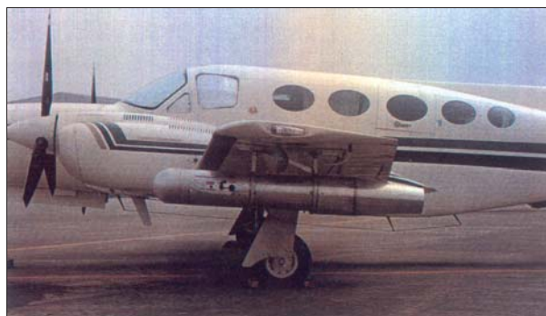
▲圖四 Cessna 421 造雨專機及其側翼下方之碘化銀燃燒器
