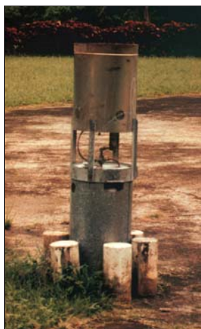
▲圖二 碘化銀地面造雨器
